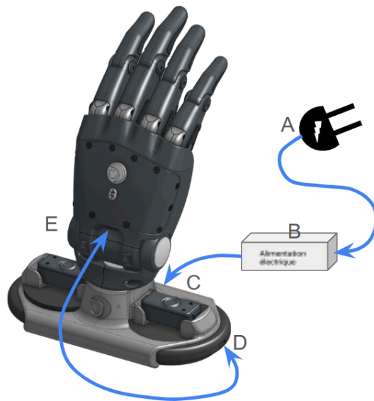
Image 8. Station de charge et alimentation avec MyoPods et Hero RGD/PRO Hand.
